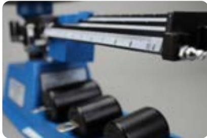
Espacio para almacenaje de las pesas
