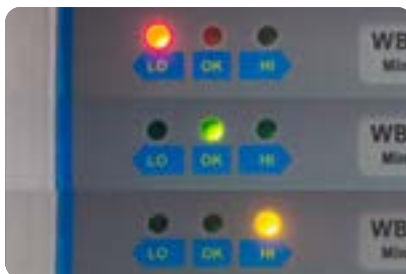
Luces LED de control de peso indican claramente si los límites están por debajo, por encima y dentro de los límites aceptables
