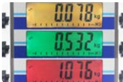
La pantalla retroiluminada cambia de color para indicar los límites de control de peso
