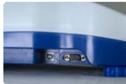
Interfaz RS-232/USB opcional para proporcionar una conexión rápida a computadoras e impresoras
