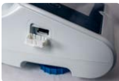
Puerto USB para transferir datos de pesaje a una memoria
